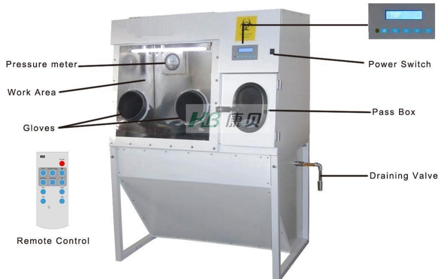
รูปที่ 17 แสดงลักษณะตู้ชีวนิรภัยประเภท Class III (ที่มา www.combi-lab-equip.com )
